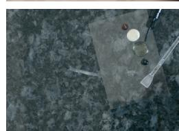
Mezclar AKELUX Filler transparent liquid con diferentes AKELUX Filler de color (máx. 50% de contenido de color) y adaptarlo al color del objeto. Si es necesario, llenar con AKELUX Structure.
